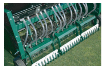
フローティングヘッドは土と種子の接触率が 高く、播種の深度を深い位置で維持します。
