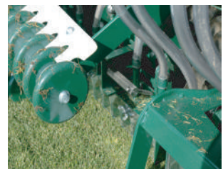
深度調整は工具無しの簡単操作で作業時のコ ンディショニングに合わせて素早く調整が可能で す。
