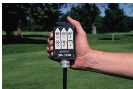
▼3ポジションスイッチ 作業品質を確実に維持する ターフコ社独自の特許獲得スイッチ
