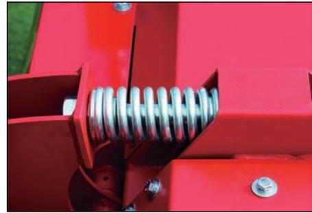
コンパクションや作業中の小石によって起こる急激な揺れや振動を、バイブラストップ及びパワーパックで吸収します。トラクターへの衝撃を最小限に抑え、快適な作業を実現します。
