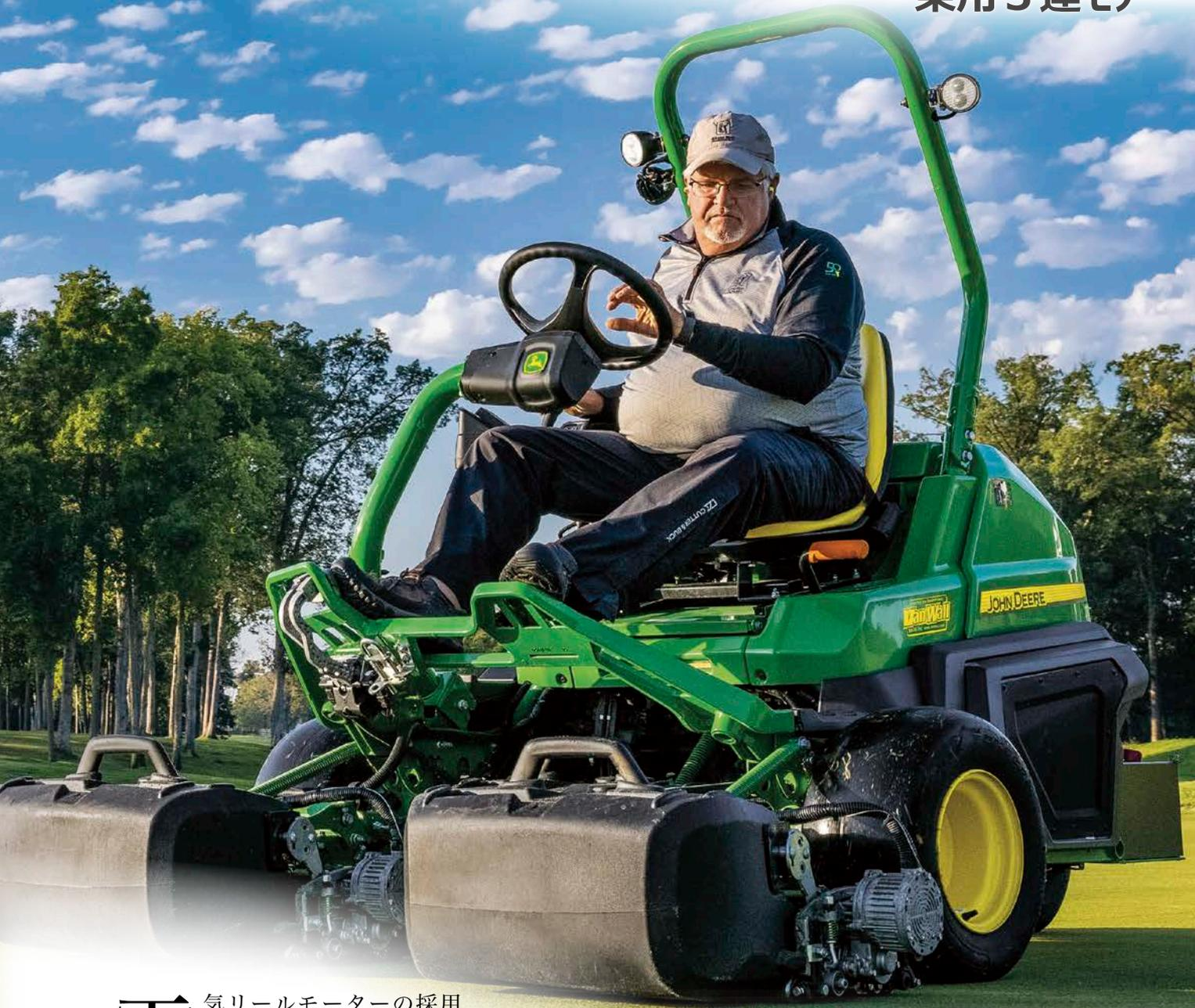
**電** 気リールモーターの採用により車速変動に左右されない均一なFOC制御が可能になりました。リール制御・作動回路を電動化し、作動油漏れの可能性を大幅に削減しました。また、エンジンは19馬力水冷ディーゼルエンジンを搭載し効率運転により低燃費、低騒音を実現しています。
