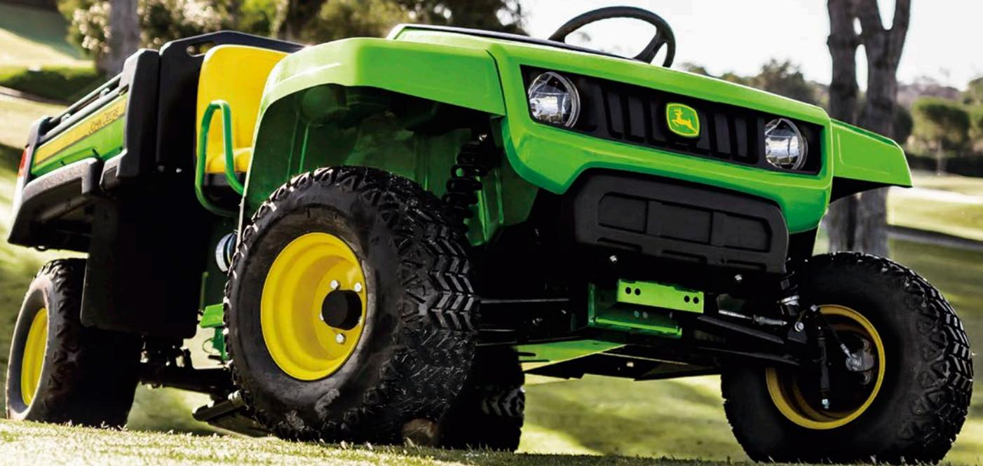
**安** 定感と低重心を目指して設計されたマシン。強力な4サイクルガスエンジンを搭載し、無段変速クラッチシステムを導入。ゴルフフィールド管理に最適な4プライ規格のターフタイヤを標準装備した高馬力、安定駆動を実現した快適な車両です。4輪油圧式ディスクブレーキ、ワイドなホイールスタンスと低重心の安定感を備えています。
